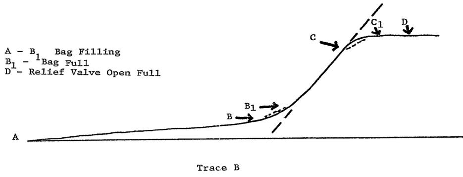
Figure 2. Relief Valve Trace
